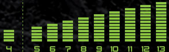
La regolazione del livello di protezione imposta automaticamente il livello di protezione adeguato in un range da 5 a 13. A tale scopo è previsto un ulteriore sensore di luminosità che rileva l'intensità dell'arco di saldatura. Così rimanete sempre perfettamente protetti indipendentemente dai parametri attualmente usati per saldare. Eventuali interventi manuali non sono più richiesti, ma naturalmente sempre possibili premendo un pulsante.
